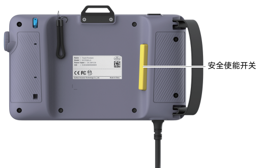
图5-2 IR-TP200系列示教器
